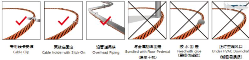
检测线缆的安装位置应远离高温火源、强磁场以及潮湿多尘的环境。
