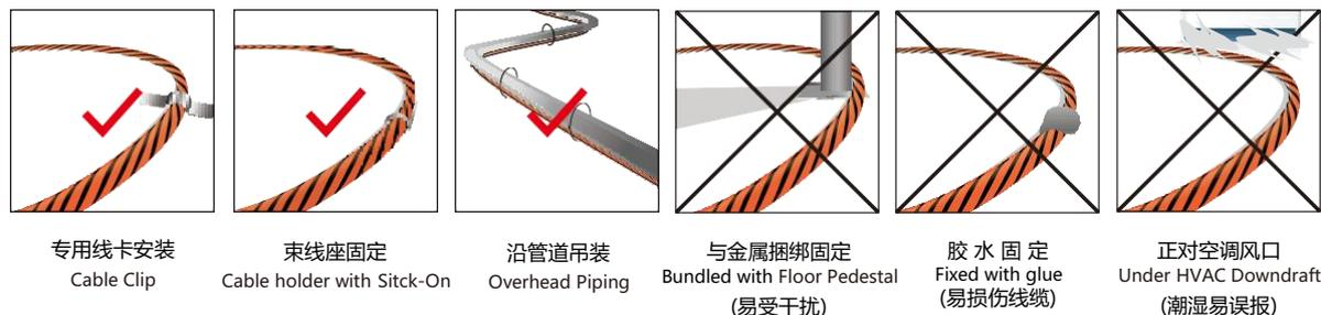
检测线缆的安装位置应远离高温火源、强磁场以及潮湿多尘的环境，
